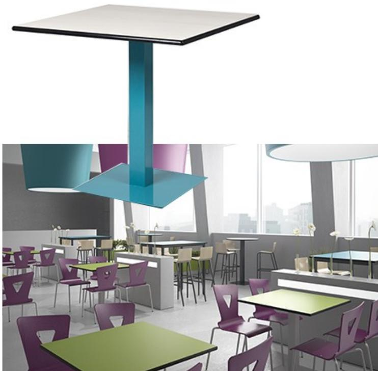
Table livrée démontée. Taille 6. Piétement monobloc acier. Montant carré 80 X 80 mm. Embase carrée ép. 8 mm munie de tampons de protection. Plateau stratifié épaisseur 22 mm avec chants alaisés bois : bordure en hêtre massif en applique sur le chant du plateau. Nombreux coloris de plateaux et de piétements, nous consulter. Existe aussi en plateau compact, nous consulter.
