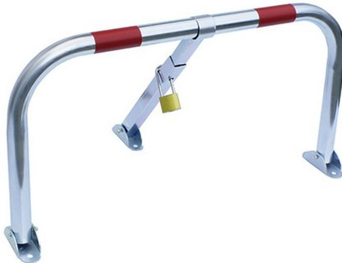
Barrière de parking avec tube en acier de diamètre 38 mm, épaisseur 15/10ème. Pied en fonte , fixation béton incluse. Fermeture par cadenas, avec clés différentes, fourni. Dim (cm) : L 75,5 x P 37 x H 40,5. poids 12.5 kg.
