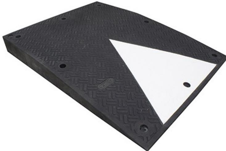
Rampe d'accès PMR en caoutchouc vierge vulcanisé avec une pente de 10%. Dim (cm) : L 75 x P 120 x H 10. Poids 70 kg.
