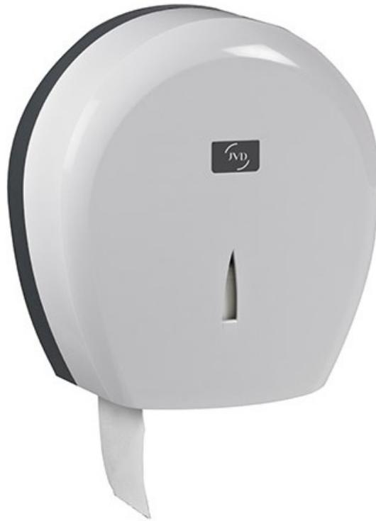
Distributeur de papier hygiénique adapté aux grands diamètres de bobine. Fermeture sécurisée à clé. Pratique : changement facile des consommables. Découpe facile droite et gauche grâce aux lames ciselées. Caractéristiques techniques : capot ABS blanc, châssis ABS gris, capacité 1 rouleau 400 m avec diamètre maxi 295 mm, mandrin universelle, visualisation du niveau de papier, 4 points de fixation. Coloris : blanc. Dims (en cm) : L31 X P12,3 X H33,4.
