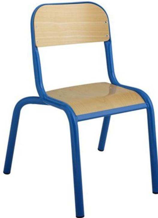
Version chants protégés : assise et dossier encastrés dans la structure et fixés par rivets. Piétement métallique. Finition des pieds par peinture époxy. Soudure avec apport de matière. Patins en PVC noir non tachant. Assise et dossier hêtre multiplis assise et dossier encastrés dans la structure et fixés par rivets.
