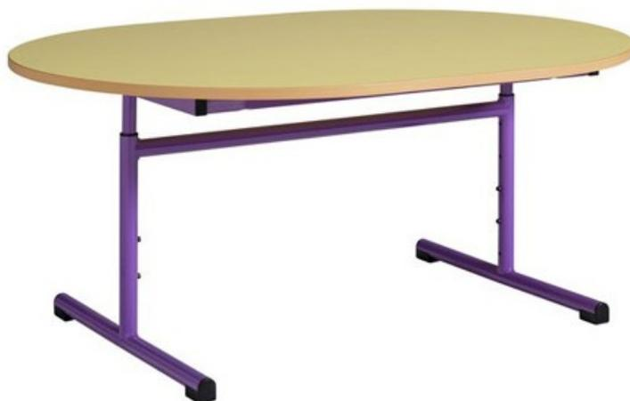
Structure à dégagement latéral. Piétement tube diamètre 32 mm pour le montant bas et l'embase, tube diamètre 25 mm pour le montant haut. Traverse de renfort tube diamètre. 32 mm. Structure sous plateau tube 40 X 20 ép. 1.5 mm. Système de réglage sur 2 points, un taquet de positionnement sur ressort et un boulon de blocage. Soudures avec apport de matière. Patins en PVC noir non tachant. Finition piétement : poudre époxy (Plusieurs finitions possibles).
