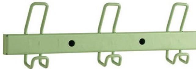
Lisse composée d'un profilé U acier de 40 X 20 X 2 mm. Gousset de renfort acier ép. 2 mm au niveau des perçages de fixation. Bipatères en étiré diamètre 6 mm permettant un double accrochage. Finition poudre époxy (plusieurs coloris au choix). Cache plastique au niveau des perçages de fixation. Visserie non fournie. Longueur 41 cm.
