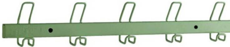
Lisse composée d'un profilé U acier de 40 X 20 X 2 mm. Gousset de renfort acier ép. 2 mm au niveau des perçages de fixation. Bipatères en étiré diamètre 6 mm permettant un double accrochage. Finition poudre époxy (plusieurs coloris au choix). Cache plastique au niveau des perçages de fixation. Visserie non fournie. Longueur 71 cm.
