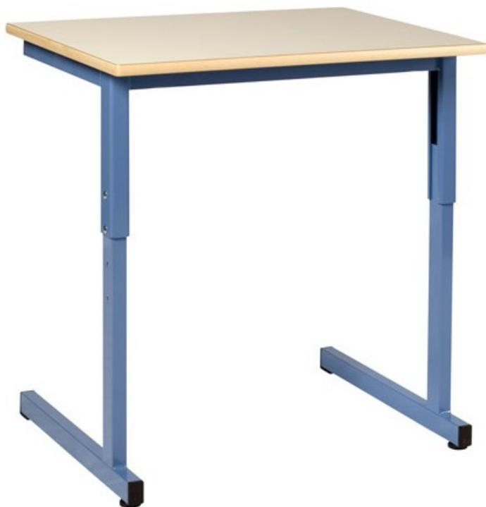
Livrée montée. A dégagement latéral. Tailles réglables de 4 à 6 en 3 positions par boulons. Montants supérieurs en tôle pliée ép. 3 mm. Montant inférieur, embases et ossature sous plateau en tube de 40 X 27 mm. Plusieurs coloris de structure au choix (nous consulter). Plateau en stratifié ép. 22 mm (plusieurs coloris au choix, nous consulter). Chants surmoulés très résistants.
