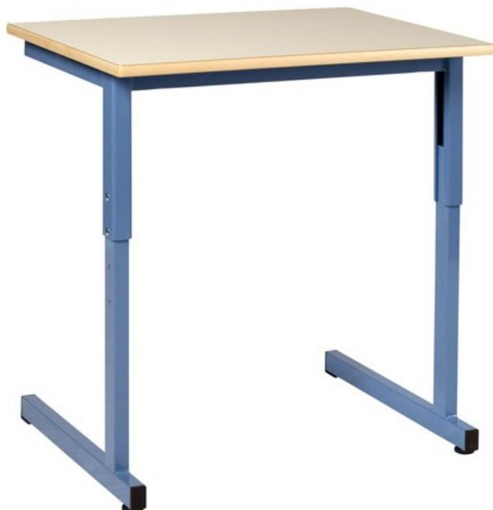
Livrée montée. A dégagement latéral. Tailles réglables de 4 à 6 en 3 positions par boulons. Montants supérieurs en tôle pliée ép. 3 mm. Montant inférieur, embases et ossature sous plateau en tube de 40 X 27 mm. Plusieurs coloris de structure au choix (nous consulter). Plateau en stratifié ép. 22 mm (plusieurs coloris au choix, nous consulter). Chants ABS.
