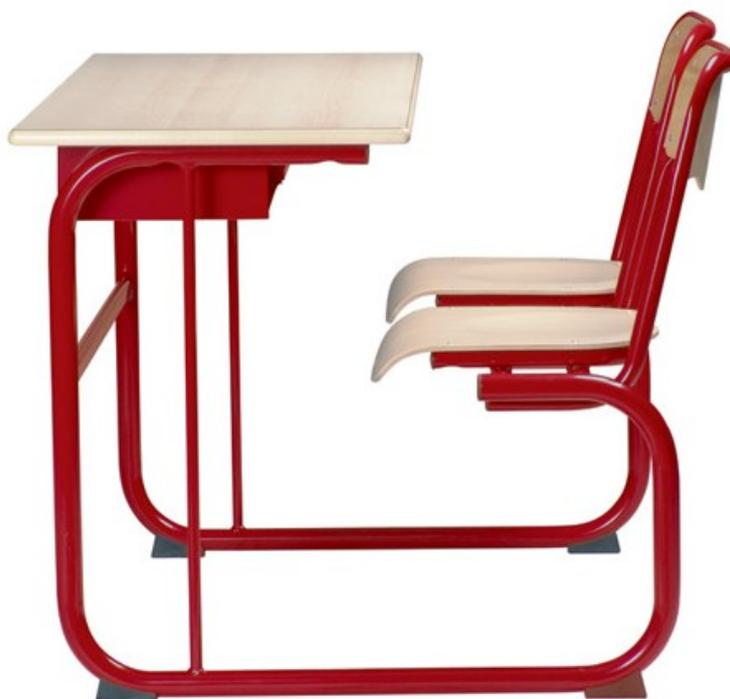
Plateau stratifié, chant alaisé hêtre massif (nombreux coloris au choix). Piétement de table en tube diamètre 35, ép. 1,5 mm avec renfort lateral en tube diamètre 16 mm. Entretoise avant en tube 36 X 18, ép. 1,5 mm. Support assise et dossier en tube diamètre 25, ép. 1,2 mm. Finition époxy (nombreux coloris au choix). Tailles T4 à T6. Livrée avec casier de rangement tôle perforée, finition époxy.
