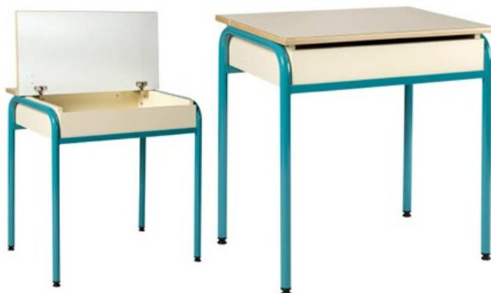
Tailles T4 à T6. Structure monobloc. Piétement en tube diamètre 30 X ép. 1,5 mm. Cornière 25 X 25 X 4 mm. Traverse tube diamètre 30 X ép. 1,5 mm. Bandeau fixe sur l'arrière. Charnière piano, fixée sur la structure par vis VBA. Soudures avec apports de matière. Finition peinture époxy, plusieurs coloris au choix. Disponible en tailles 4, 5 et 6. Livrés montés. Garantie 10 ans. Disponible en tailles 4, 5 et 6. Livrés montés. Garantie 10 ans.
