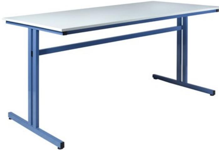
Table à piétement latéral. Montants et embases tube rectangulaire 40 X 27 mm. Ossature sous plateau tube de 30 X 30 mm. Vérins de réglage. Finition peinture époxy, plusieurs coloris au choix. Plateau stratifié chant ABS : panneau de particule ép. 19 mm, recouvert de stratifié haute pression 8 10ème sur les deux faces. Epaisseur totale 22 mm. Chant ABS ép. 2 mm collé à chaud en applique sur le panneau. Hauteur 100 cm. Dims (cm) : 160 X 80.
