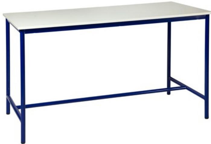
Structure métallique monobloc tube diamètre 32 mm. Piétement entretoisé tube diamètre 32 mm. Finition peinture époxy, plusieurs coloris au choix. Plateau mélaminé chant ABS : panneau de particules surfacé mélaminé ép. 19 mm. Chant ABS ép. 2 mm collé à chaud en applique sur le panneau. Hauteur 90 cm. Livrées montées.
