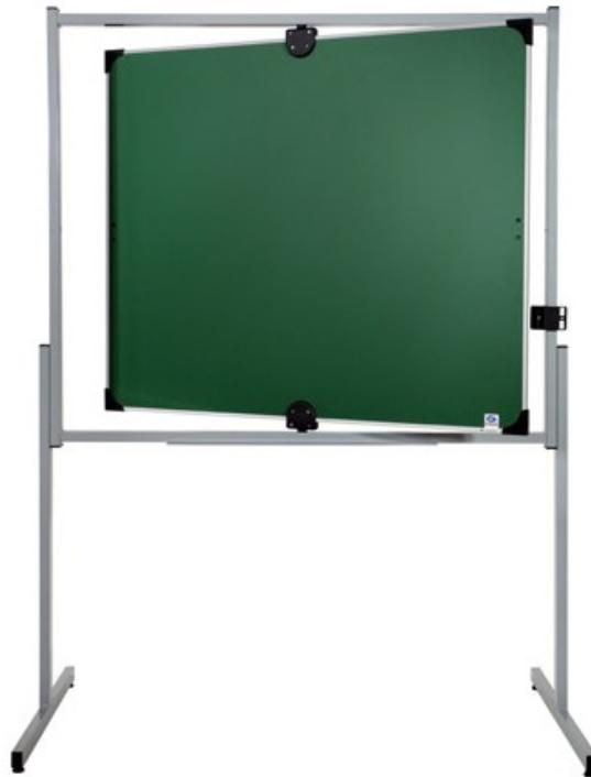
Surface d'écriture en tôle émaillée vitrifiée. Affichage magnétique possible. Effaçable à sec. Chants verticaux en profilés U aluminium anodisé, angles protégés par des protections plastiques. Châssis en tube d'acier mécano soudé laqué. Empattement des pieds du châssis : 70 cm. Auget porte accessoires. Pieds équipés de vérins réglables.
