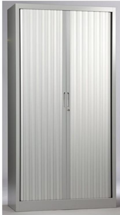
Garantie 2 ans. Conforme à la norme AFNOR D62-041. Corps en tôle laminée à froid répondant à la norme NF A 36-401, structure entièrement soudée. Dessus et bandeau de socle en tôle 10,10e. Lames terminales de fermeture en tôle 10,10e post-formées anti-intrusion. Côtés, fond, socle, panneaux intérieurs et tablettes en tôle 8 10e. Les armoirettes (H
