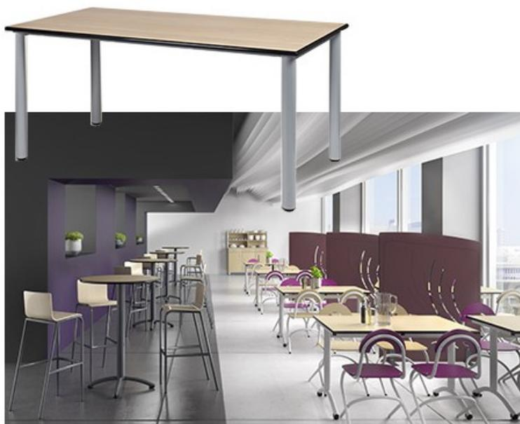
Tailles de 1 à 6. Garantie 10 ans. Piètement 4 pieds : structure démontable. Piètement tube diamètre 40 mm ép. 1,5 mm, manchonné et vissé. Vérins et embouts de réglage en polyéthylène noir non tachant. Ossature périphérique sous plateau tube de 30 X 30 mm. Plateaux stratifié ép. 22 mm. Chants alaisés bois : Bordure en hêtre massif sur le chant du plateau et recouvert par du stratifié ép. 10 10 ème sur les 2 faces. Plusieurs coloris de plateau et de piètement au choix.
