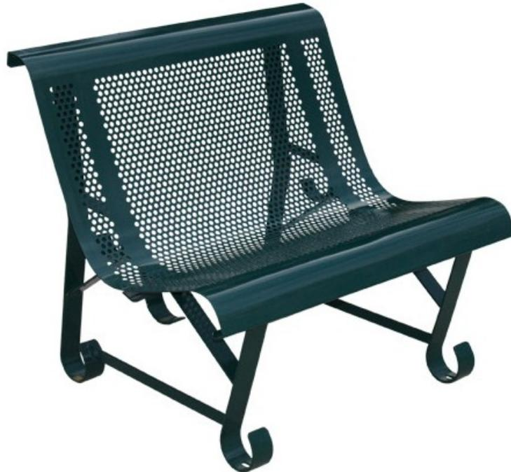
Idéal pour agrémenter vos parcs et jardins avec des fauteuils confortables et robustes Assise en tôle perforée épaisseur 15 10e, trous rond diamètre 10 mm. Pieds en fer plat de 50 X 5 mm. Volutes en fer plat de 40 X 4 mm. Finitions : peinture polyuréthane cuite au four. Coloris vert RAL 6005. Autres coloris RAL possibles, nous consulter. Dims (cm) : L 80 X H 74. Hauteur d'assise : 36. Poids : 17 kg. A poser ou à sceller.
