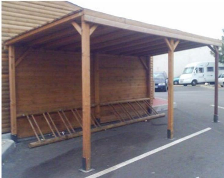
Structure tout bois, essence pin nord rouge Finlande, catégorie 5, gage de stabilité et de haute résistance. PEFC. Traitement autoclave classe IV, sans chrome ni arsenic. Poteaux section 120 X 120 mm, chevron section 68 X 68 mm. Fond en clin plat ou clin bombé au choix.
