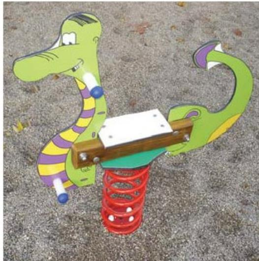
Figurine en compact imputrescible ép. 12 mm, sérigraphie 2 faces. Elément de liaison en pin du nord, traitement autoclave classe III. Visserie galvanisée. Livré avec 3 platines de scellement L40 cm. Hauteur de chute 53 cm. Surface amortissante 7 m2.
