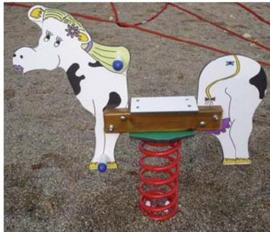
Figurine en compact imputrescible ép. 12 mm, sérigraphie 2 faces. Elément de liaison en pin du nord, traitement autoclave classe III. Visserie galvanisée. Livré avec 3 platines de scellement L40 cm. Hauteur de chute 53 cm. Surface amortissante 7 m2.
