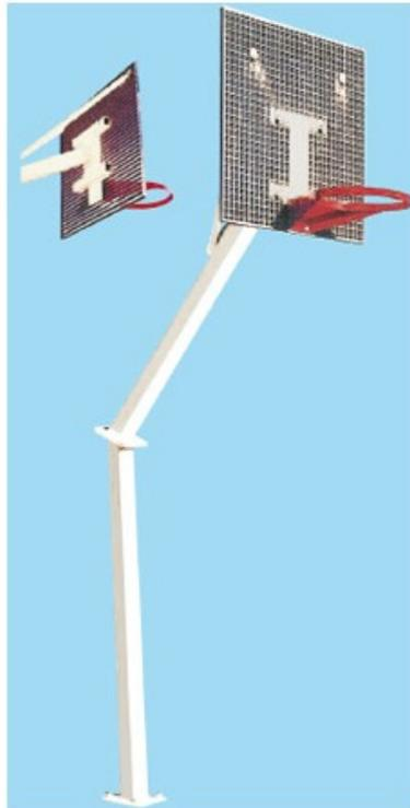
But de basket robuste sur platine. Hauteur du panier 3,05 m. Poteau en tube de section 100 X 100 mm avec déport de 1,20 m. Panneau 100 X 100 cm en caillebotis galvanisé épaisseur 30 mm. Cercle anti-vandalisme renforcé en fer plat de 40 X 5 mm. Finition peinture au four blanc RAL 9010. A fixer grâce à la platine avec tiges filetées (fournies) . Visserie fournie.
