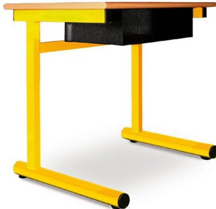
Structure à dégagement latéral en tube d'acier diamètre 45 mm pour la base, traverse de réglage en tube de 40 X 30 mm. Versions réglables au choix par molettes ou vis type BTR. En version réglable : taille 4, 5, 6. En option : casier et crochet porte cartable. Dim (cm) : 70 X 50.
