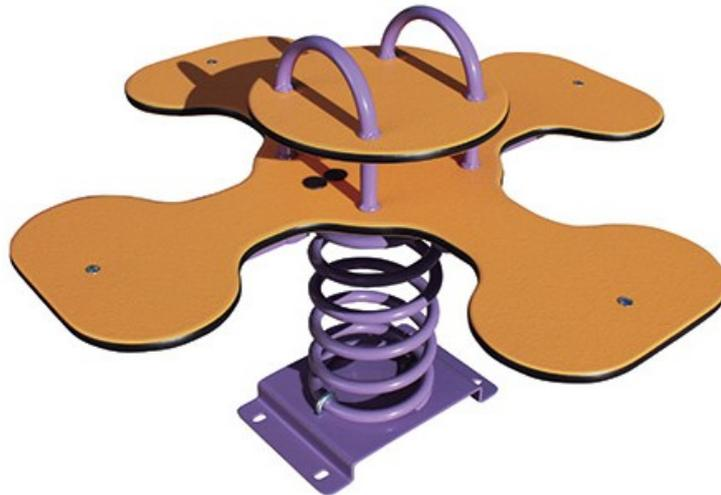
Jeux à ressort pour enfants de 1 à 12 ans, conforme à la norme EN 1176. Hauteur de chute 0,42 m. Espace d'implantation : 308 X 308 cm. Ressort en acier, finition peinture poudre polyester. Forme et assise en HPL, coloré et d'une grande stabilité. Boulonnerie en inox.
