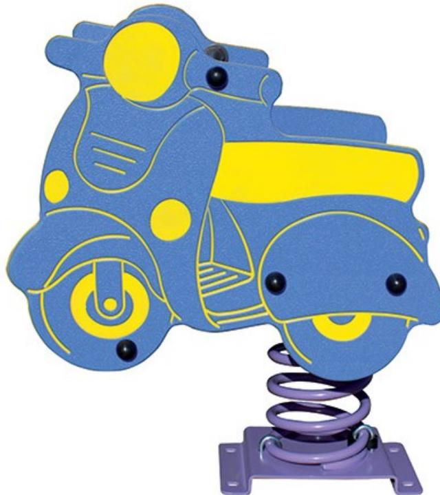
Jeux à ressort pour enfants de 1 à 12 ans, conforme à la norme EN 1176. Hauteur de chute 0,42 m. Espace d'implantation : 269 X 237 cm. Ressort en acier, finition peinture poudre polyester. Forme et assise en polyéthylène, coloré et d'une grande stabilité. Boulonnerie en inox.
