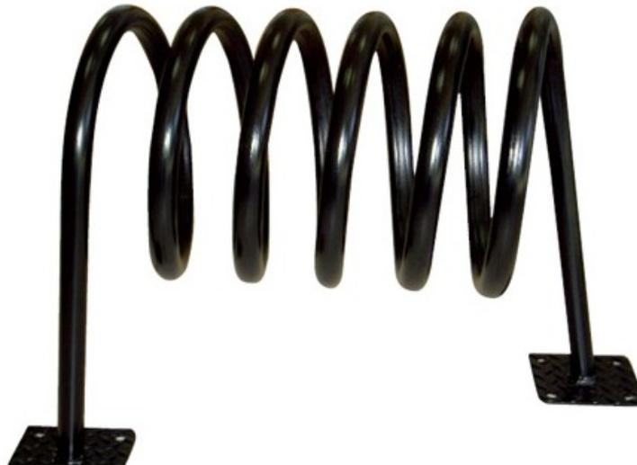
Range vélos 4 places double accès. Réalisé en tube d'acier rond diamètre 33,7 X 2,9 mm. Finition peinture époxy noire. Fixation au sol par chevillage chimique. Dims (cm) : L 84 X P 41 X H 55.
