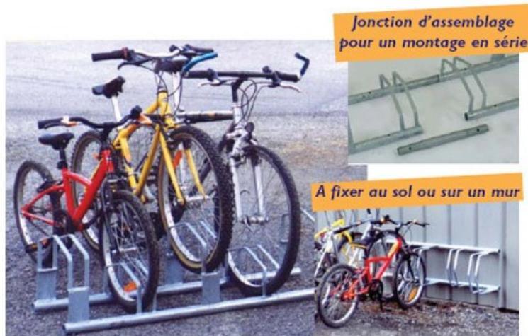
A fixer au sol ou au mur. Ossature en tube métallique galvanisé diam. 40 mm. Arceaux en fer plat galvanisé de 16 X 6 mm espacés de 30 cm, avec modules décalés en hauteur de 15 cm, pour mettre les vélos côte à côte dans un minimum d'espace, sans qu'ils ne se touchent par les guidons. Les différents modèles peuvent être installés côte à côte grâce à la jonction d'assemblage en option. L. 0.70 x 0.35m
