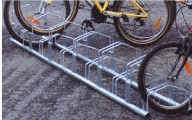
A fixer au sol ou au mur. Ossature en tube métallique galvanisé diam. 40 mm. Arceaux en fer plat galvanisé de 16 X 6 mm espacés de 30 cm, avec modules décalés en hauteur de 15 cm, pour mettre les vélos côte à côte dans un minimum d'espace, sans qu'ils ne se touchent par les guidons. Les différents modèles peuvent être installés côte à côte grâce à la jonction d'assemblage en option. L. 1.28 x 0.35m
