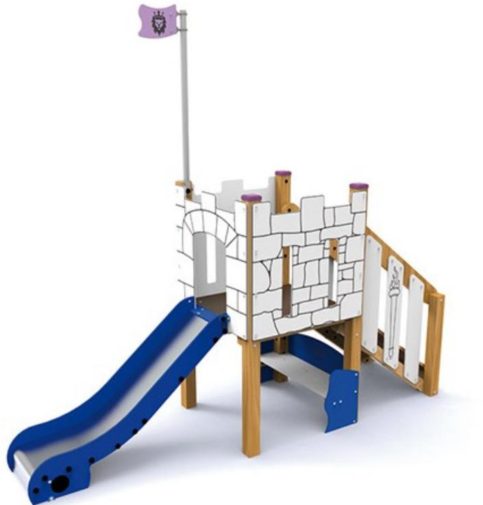
Structure de jeux pour enfants de 1 à 6 ans, conforme à la norme EN 1176. Composée de : 1 plateforme, 1 rampe d'accès, 1 toboggan à glissière inox, 1 espace cabane avec banc sous la plateforme. Hauteur de chute 0,90 m. Espace d'implantation : 707 X 402 cm. Structure en pin sylvestre traité autoclave classe 4 ou stratifié collé multicouches. Panneaux décoratif et toit en polyéthylène, coloré et d'une grande stabilité. Boulonnerie en inox.
