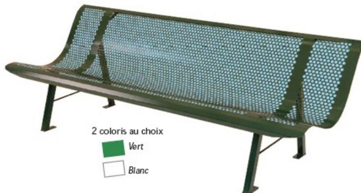
Réalisé en tôle perforée épaisseur 2 mm. Finition sous-couche époxy + laque polyuréthane cuite au four. Ossature sous assise renforcée par un plat de 50 X 10 mm. Pieds en profilé métallique avec pattes de fixation. 2 coloris au choix (vert ou blanc) à préciser à la commande.
