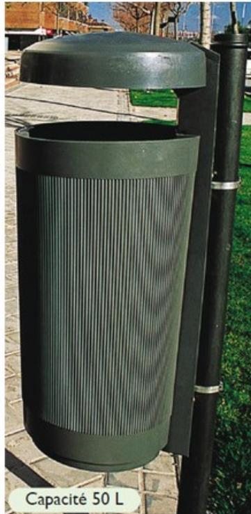
Réalisée en Polyéthylène Haute Densité (PEHD) injecté. Résistante aux U.V. Modèle à installer sur poteau à sceller (option) ou sur support existant. Verrouillage par clé triangulaire standard. Le relief des parois empêche la pose sauvage d'affiches et de graffitis. Coloris : vert. Autres coloris possibles à partir de 25 unités : noir, gris, bleu foncé, vert clair. Dims (cm) H X diamètre : 84 X 35. Poids : 6 kg.
