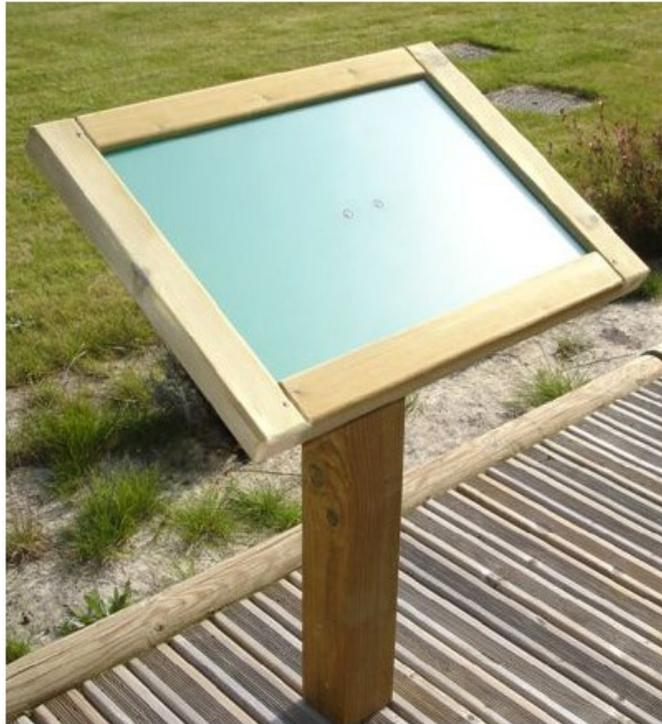
Structure bois avec ou sans fenêtre, essence pin nord rouge Finlande, catégorie 5, gage de stabilité et de haute résistance. Traitement autoclave classe IV, sans chrome ni arsenic. Poteau section 120 x 120 mm, longueur totale 1,30 m pour hors sol 0,80m. Cadre dim utile 600 x 400 mm. Support en compact 10 mm + plexiglas. Poids : 19 kg.
