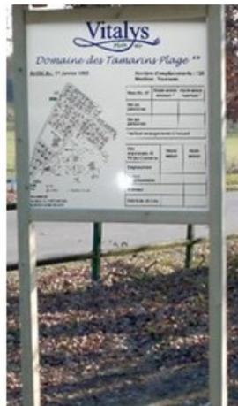
Panneau d'affichage sans toit. Essence PIN NORD ROUGE origine FINLANDE et/ou SUEDE, catégorie 5, gage de stabilité et de haute résistance ; - Traitement autoclave sous pression, classe 4, solution aqueuse sans chrome ni arsenic. - Hauteur hors sol : 2,420 m - Largeur : 1,140 m - Panneau en PVC komacel ép.10 mm - Surface d'affichage 960 x 960 m. - Livré pré monté à sceller - Visserie INOX A2
