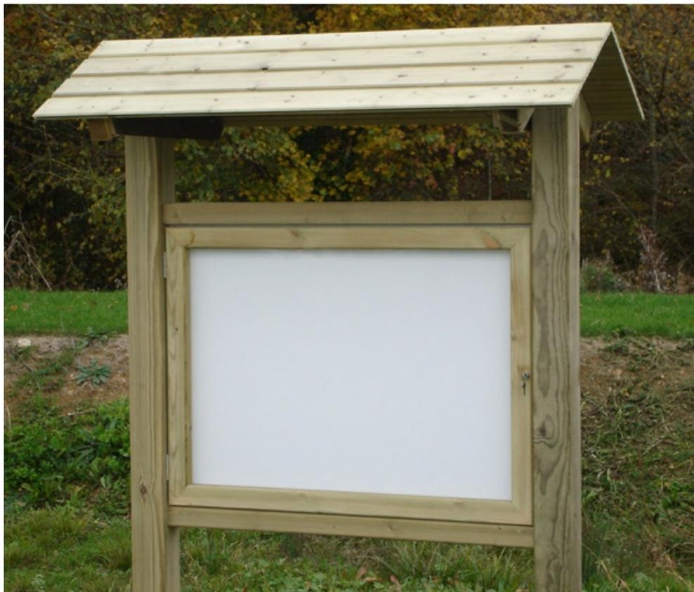
Version avec vitrine et avec toit. Structure bois essence pin nord rouge Finlande, catégorie 5, gage de stabilité et de haute résistance. Traitement autoclave classe IV, sans chrome ni arsenic. Visserie inox A2. Panneau en compact ép. 10 mm ou PVC komacel ép. 10 millimètres. Hauteur hors sol : 242 cm. Largeur : 154 cm. Surface d'affichage : 130x130cm. Visible sous vitrine : 117x117 cm. Verrou avec serrure. Livré pré monté, à sceller. Panneau une face non aimantée.
