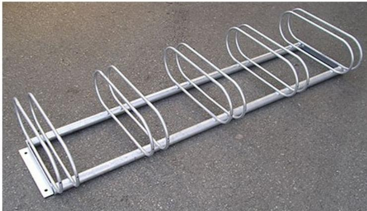
Corps en tube acier de diamètre 33.7 mm. Arceaux en tube acier de diamètre 12 mm. Finition galvanisé. Dim (cm) : Corps : L 158 x H 22, Support : L 51.5 x H 18. Poids 10 kg.
