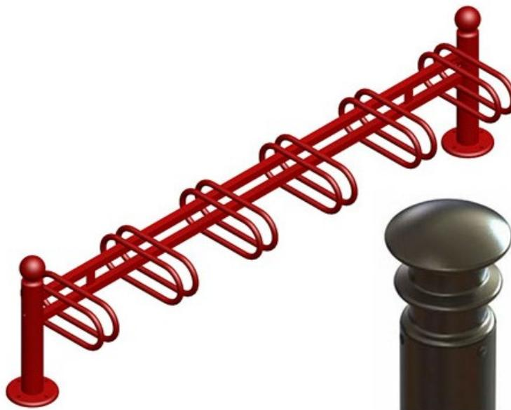
Support vélo 6 places, thermolaqué, coloris au choix nous consulter. Poteaux en tube acier de diamètre 76 mm. Traverse en tube acier 30x30. Arceaux en tube acier de diamètre 22 mm. Modèle sur platine. Dim (cm) : L 225.5 x H 56.2, hors sol 105. Poids 24.5 kg.
