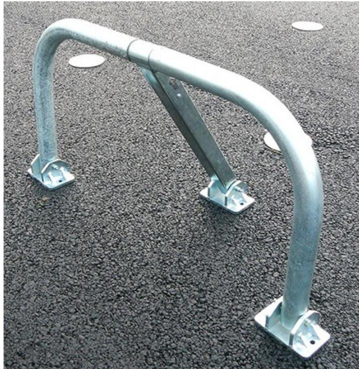
Bloc parking avec serrure clé unique. Verouillage automatique en remontée. Corps en tube acier de diamètre 48.3 mm. Glissière composée d'un tube acier de 40x40 mm coulissant dans un tube acier de 45x45 mm. Finition electro-zingué. Dim (cm) : L 84.8 x H 47.4 x P 40.5. Poids 9 kgs.
