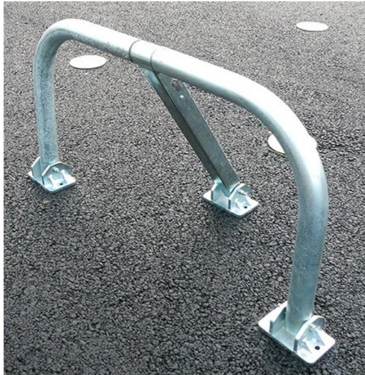
Bloc parking avec serrure clé triangle. Verouillage automatique en remontée. Corps en tube acier de diamètre 48.3 mm. Glissière composée d'un tube acier de 40x40 mm coulissant dans un tube acier de 45x45 mm. Finition electro-zingué. Dim (cm) : L 84.8 x H 47.4 x P 40.5. Poids 9 kgs.
