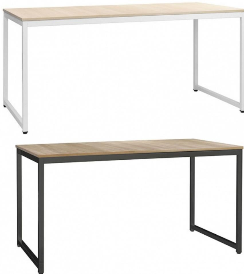
Bureaux modernes aux lignes épurées. Plateaux mélaminés d'épaisseur 18 mm, chants PVC 2 mm. Piétement métallique en « O », tube d'acier carré 30 x 30 mm. Cadre sous plateau 40 x 20 mm, pré-fixé pour montage rapide. Vérins de réglage, course de 12 mm. Installation très simple (4 vis seulement). Deux combinaisons de coloris au choix : piétement blanc et plateau chêne blanchi ou piétement anthracite et plateau noyer.
