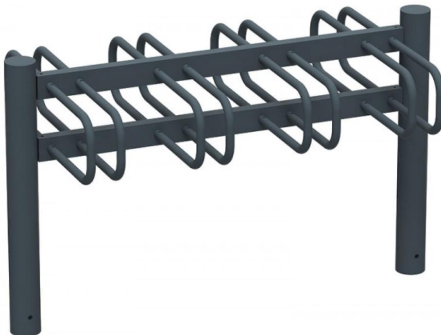
Appui vélos design et robuste 8 places fabriqué en acier traité anti-corrosion. Finition peinture poudre anti-UV, coloris anthracite mat 7016. Tête dôme en acier ép. 2 mm. Poteaux en tube d'acier diamètre 76 mm. Traverses en tube d'acier 40 x 40 mm. Range-vélos en tube rond plein diamètre 21 x 3 mm. A sceller hauteur 20 cm (perçage diamètre 12 mm pour fer à béton (non fourni). Dims (cm) : L112,5 x P61,1 x H71. En option, nous consulter : personnalisation, autres coloris. Fabrication Française.
