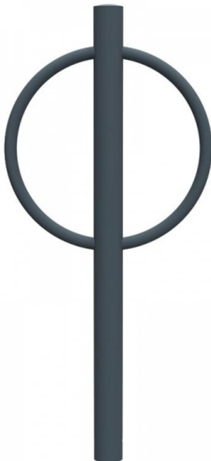
Appui vélos design et robuste 2 places fabriqué en acier traité anti-corrosion. Finition peinture poudre anti-UV, coloris anthracite mat 7016. Tête dôme en acier ép. 2 mm. Tube diamètre 76 x 3 mm. Oreilles latérales pour fixation des cycles en tube d'acier diamètre 32 mm. A sceller hauteur 20 cm (perçage diamètre 12 mm pour fer à béton (non fourni). Dims (cm) : L53 x H120. En option, nous consulter : personnalisation, autres coloris. Fabrication Française.
