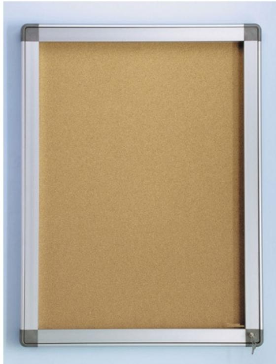
Profils aluminium anodisés 5 mm. Coins polycarbonate chargé à 10 en fibre de verre, aspect aluminium. Verre 4 mm posé siliconé. Serrure de sécurité pour intérieur intégrée dans le coin avec tringle de verrouillage (2 points d'ancrage). Epaisseur totale : 4,4 cm Epaisseur utile : 2,4 cm. Fixation par 4 vis et 4 chevilles (fournies).
