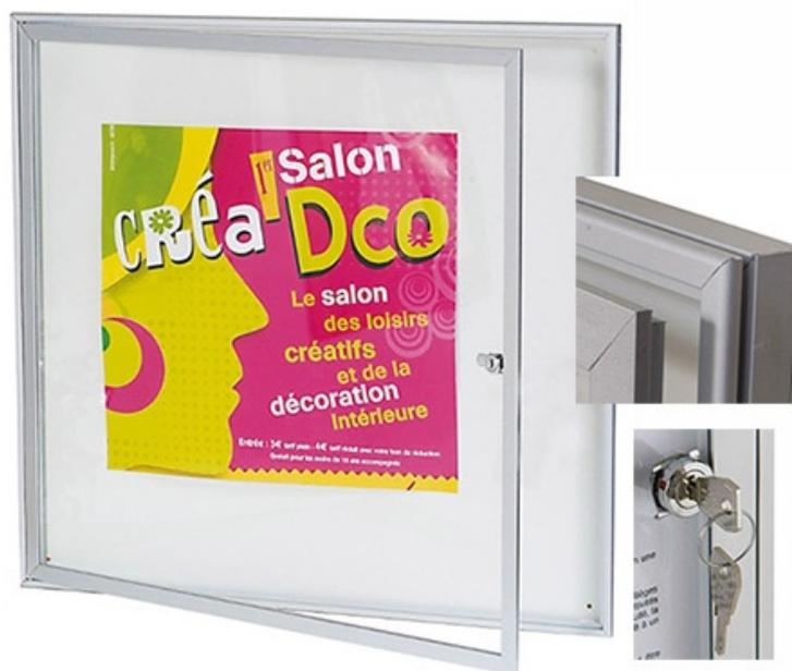
Vitrine idéale pour les espaces réduits, extra-plate. Epaisseur : 20 mm. Vitrine intérieure avec cadre en aluminium anodisé. Vitrage méthacrylate. Modèles sans entourage. Fond métallique pour utilisation magnétique. Fixation murale aux 4 coins. Serrure à clés, 1 serrure. Modèle 4 A4. Dims (cm) : L46,1 x P2 x H63,5.
