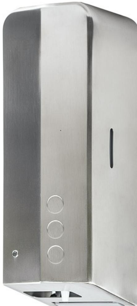
Distributeur de savon liquide ou gel hydroalcoolique automatique conçu pour les espaces publics à haute fréquence d'utilisation. Boîtier en inox AISI 304, finition satiné. Capteur infrarouge électronique qui arrête le distributeur dès que les mains sont retirées du champ de détection. Fonctionne avec 6 piles de 1,5 V. Fenêtre de contrôle de niveau. Verrou de sécurité. Contenance 1000 ml. Dim (cm) : L10,5 x P9,5 x H27,5.
