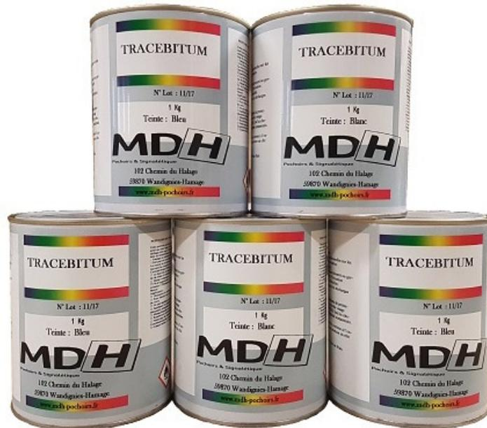
Peinture routière acrylique aspect mat mono composant conçue pour les axes routiers. Temps de séchage très court : moins de 5 minutes au toucher et 30 minutes à la remise en circulation. Traçage sur enrobé extérieur fort pouvoir couvrant. Pot de 1 kg.
