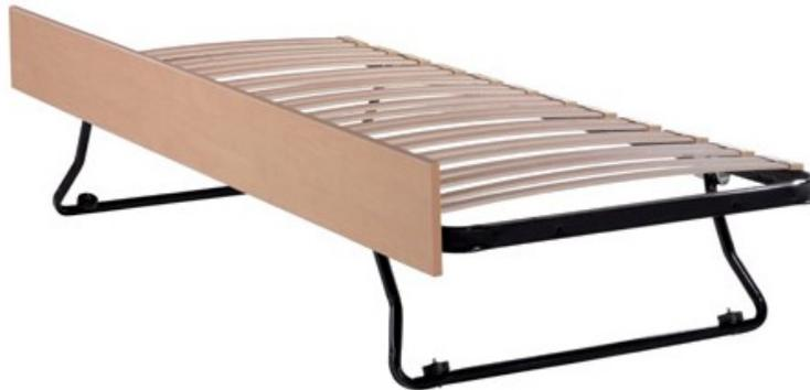
Cadre métallique en tube 40x27 mm cintré sur chant. Embouts doubles en PVC clipsés. 24 doubles lattes multiplis (hêtre ou bouleau) largeur 38 mm épaisseur 8 mm. Pieds métalliques en tubes diamètre 25 mm escamotables par ressorts. Roulettes diamètre 50 mm montés sur les pieds. Façade en mélaminé ép. 19 mm chants ABS 2 mm. Finition epoxy gris anthracite. Mélaminé.
