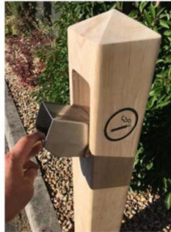
Un cendrier borne très pratique et adapté aux espaces verts. Cendrier articulé en inox. Borne fabriquée en pin traité autoclave classe IV avec tête au choix : pointe de diamant ou coupe en biais. Section 120 x 120 mm. Picto gravé et peint. A sceller. Hauteur 110 cm. Poids : 14 kg.
