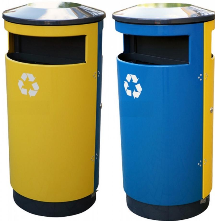
Moderne, simple et pratique, cette corbeille permet d'effectuer facilement un tri sélectif. En acier galvanisé, elle est à poser ou à sceller. Finition avec peinture polyester labellisée haute résistance et traitement anti-corrosif et anti-UV. Support sac. Serrure automatique. Plusieurs coloris au choix, nous consulter. Dims (cm) : Ø 42 X H 87. Volume : 2 X 40 Litres. Poids : 21 kg.
