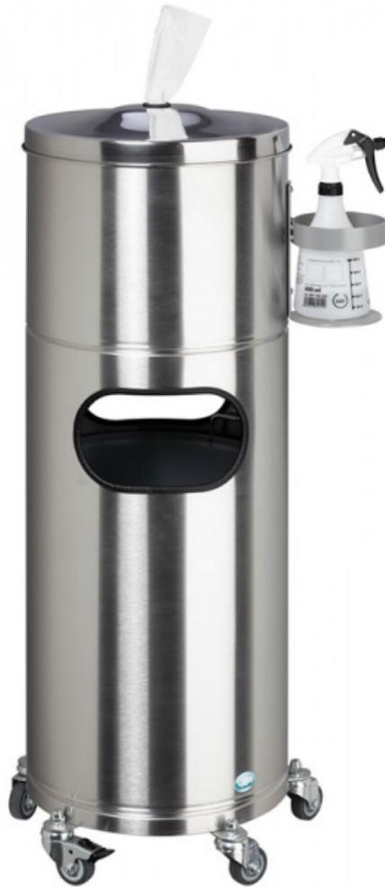
Fabrication du corps et du dévidoir des papiers en inox. Couvercle en inox mat avec ouverture (ouverture avec douille caoutchouc) pour le prélèvement du papier. Porte-bouteille avec console en tôle d'acier et revêtement par peinture poudre coloris "argent", vissée à la partie médiane. Le cadre mobile fabriqué en inox avec 5 roulettes pivotantes dont 2 avec frein. Livraison avec seau intérieur galvanisé (env. 32 L). Dims (cm) : L46 x P38 x H101. Poids : 15,4 kg.
