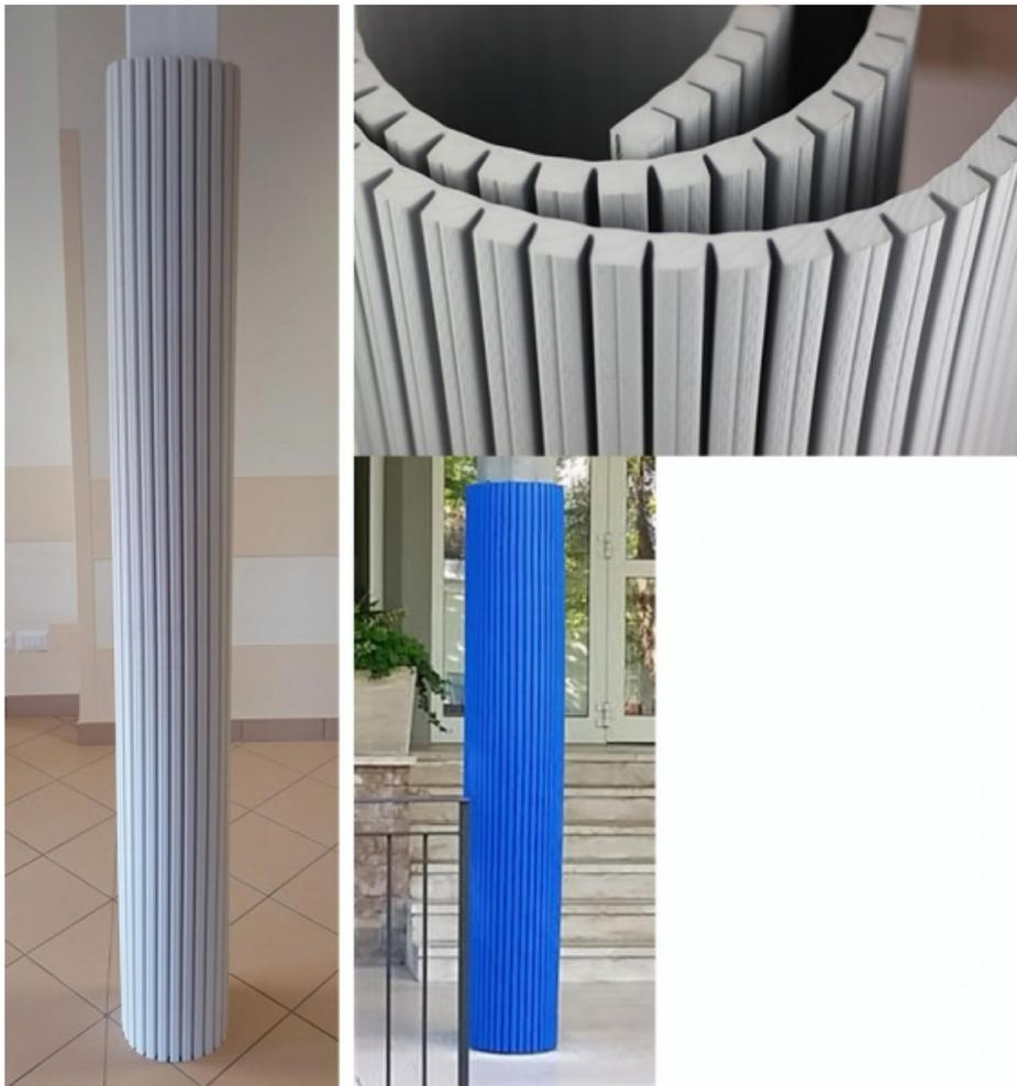
Protection pour poteaux et murs absorbant les chocs. Convient à l'extérieur comme à l'intérieur, résistant aux intempéries. Résistant aux morsures. Facile à nettoyer. Matériaux antitoxiques. Deux coloris au choix : bleu RAL 5015 ou gris RAL 7045. A installer avec une colle MS Polymer ou Néoprène ( non fournie). Certification EN 71 et UNI 913:2009. Dims (cm) : L200 x P2 x H100.
